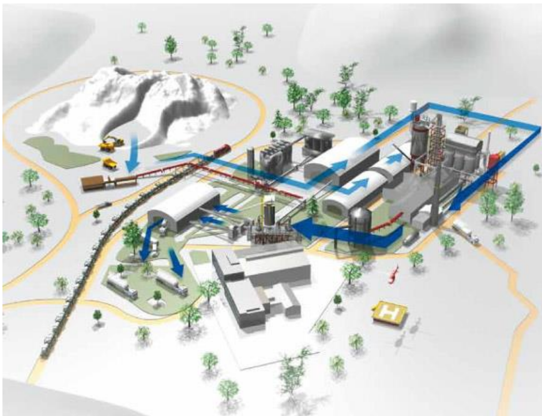
Figura 2: Cadeia produtiva do cimento. Fonte: InterCement online. Disponível em: < http://www.intercement.com/sites/ra2010/pt/nossos-negocios/cadeia-produtiva.asp >
