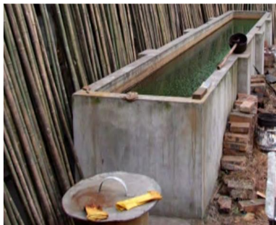
Figura 31: Piscina de concreto para tratamento. Fonte: (Bamboo Training Manual , 2012 p. 33)
