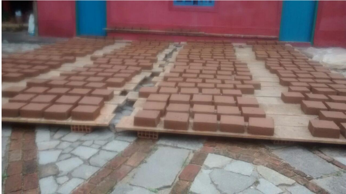
Figura 20 Secagem de adobes ao ar livre. Fonte: Foto cedida por Joana Sousa
