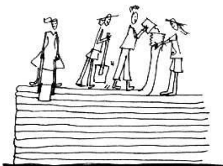
Figura 9: Montagem das paredes de superadobe. Fonte: Brasil. Ministério do Meio Ambiente. 2008)
