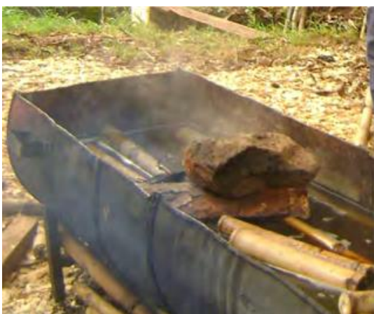
Figura 30: Recipiente para tratamento feito com barris soldados. Fonte: (Bamboo Training Manual, 2012 p. 32)
