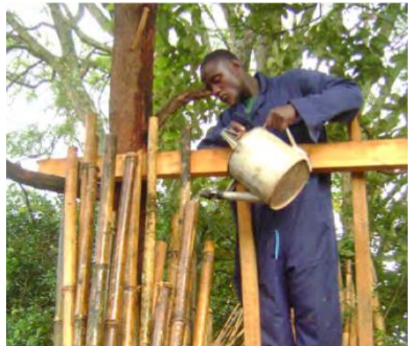
Figura 29: Colmos posicionados verticalmente e sendo preenchidos com a solução. Fonte: (Bamboo Training Manual , 2012 p. 29)
