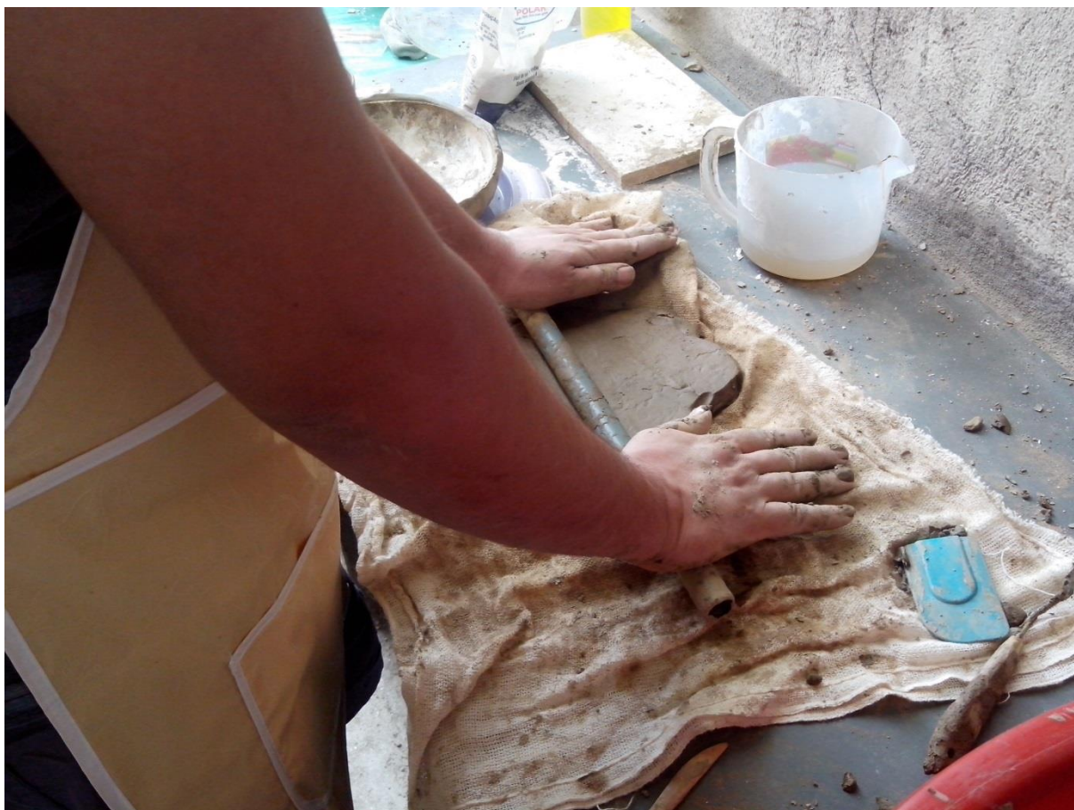
Figura 15. Com o auxílio de um cano de pvc de 1½' faz-se placas de argila para a confecção das partes dos vasilhames
